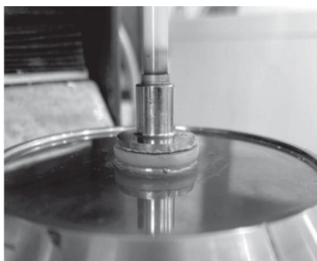
Рис. 1. Фотография узла реометра при испытании
